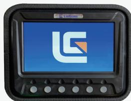
动态监控作业工况，实现智能调节压力和流量、远程操控、远程诊断机器故障、信用管控等功能。
